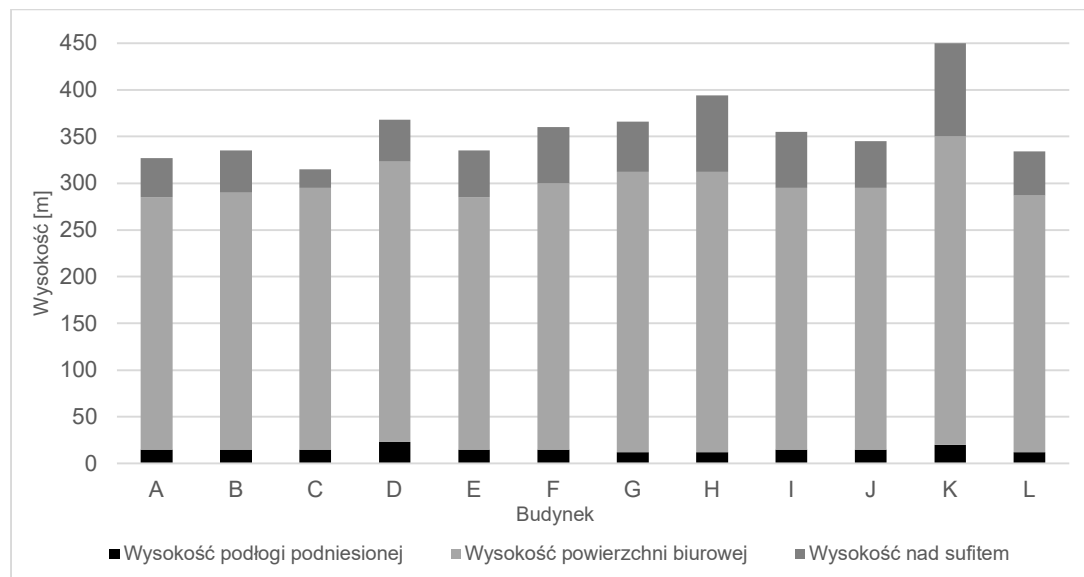
Rysunek V.3.38. Zbiorcze zestawienie wysokości kondygnacji
